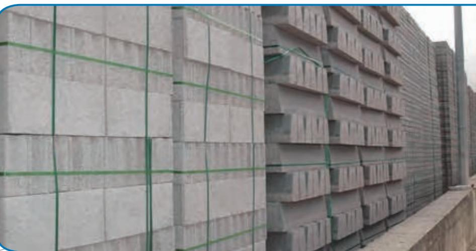
Artefactos pré-fabricados em betão vibrocompactado. Gama diversa de artefactos produzidos em betão com alta prensagem.
